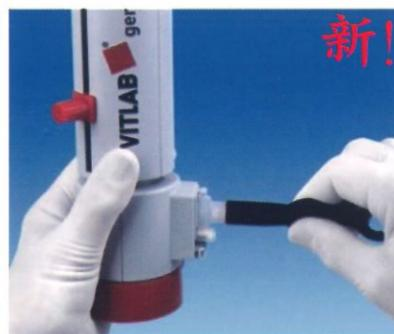
新! 全新安全閥設計，在無安裝排液管的狀態下試劑不會流出，讓您清洗儀器時更加安全。
