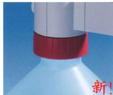
新! 儀器的口徑統一為 GL45，並附有轉接頭，適用符合國際規格各種尺寸試劑瓶。
