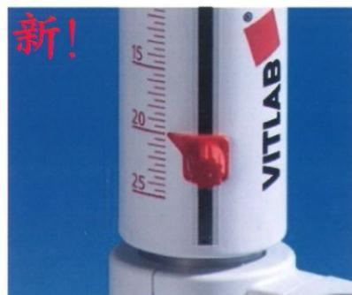
新! 指針式容積控制鈕，增加鋸齒軌道設計，調整容積更方便及精準。
